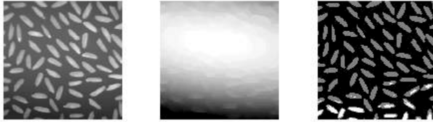
Figura 15. División de imágenes, se muestra la división de la imagen original (izquierda) entre el fondo (centro) dando como resultado la figura de la derecha.
